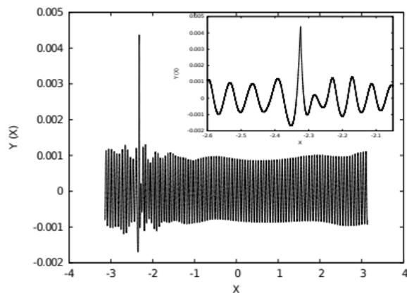
Figure: Образование волны-убийцы при  $t=802$  (полностью нелинейные уравнения)
