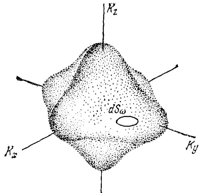
Рис. 6.10а. Элементарная площадка  $dS_\omega$  на поверхности постоянной частоты в  $\mathbf{K}$ -пространстве. Объем слоя между двумя поверхностями постоянной частоты  $\omega$  и  $\omega + d\omega$  равен  $\int dS_\omega d\omega / (\text{grad}_K \omega)$ .
